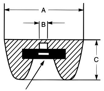
Finns med eller utan ingjuten bricka. With or without a steel washer.
